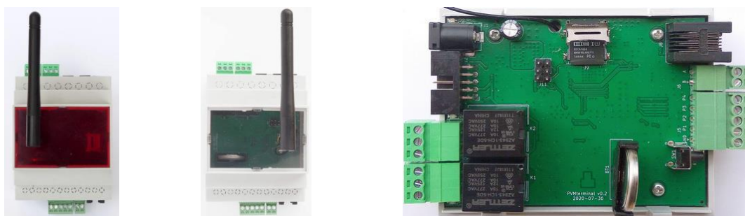
Rys. 3. Wygląd urządzenia PVMterminal i PVMterminal Plus w obudowie i po zdjęciu pokrywy górnej
